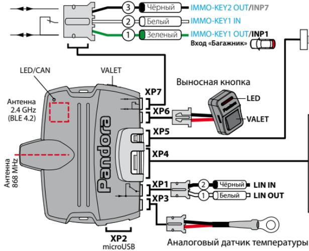
**ВНИМАНИЕ!** Базовый блок рассчитан для работы при температуре от  $-40^{\circ}\text{C}$  до  $+85^{\circ}\text{C}$ , степень защиты – категория IP40.
